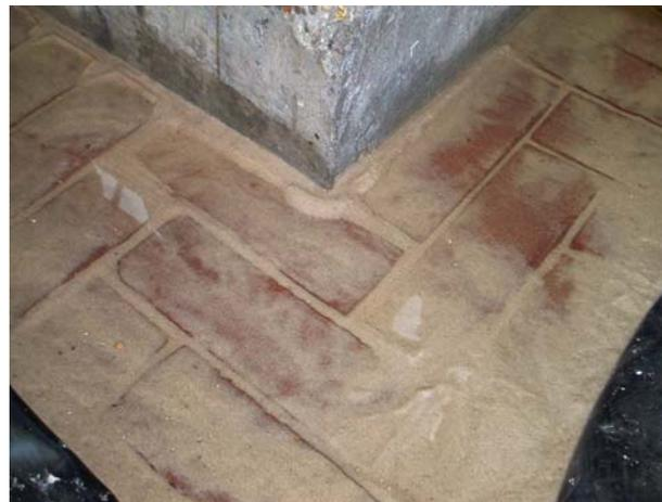
Figure 4: jointoiement comprimé (en labo).
